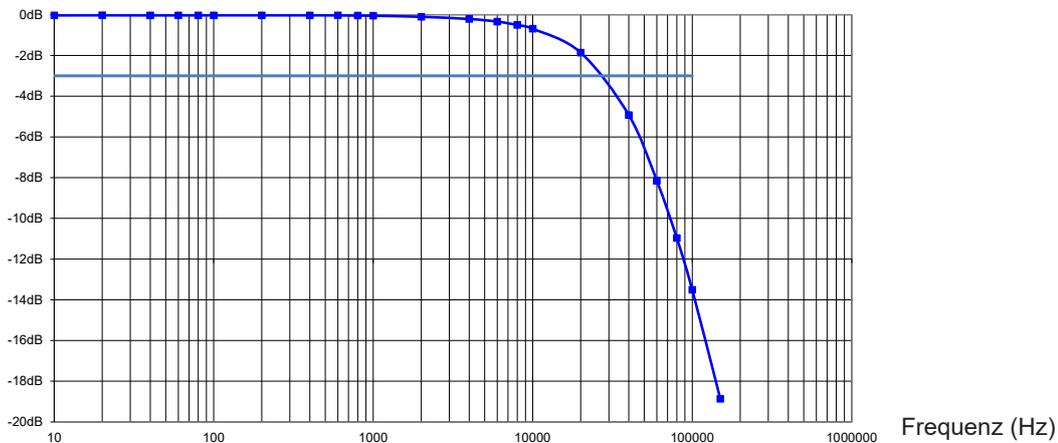
Typische Amplitudenfehlerkurve als Funktion der Frequenz,  $I = 0,5 \text{ A}$ , im Messbereich  $1 \text{ V/A}$
