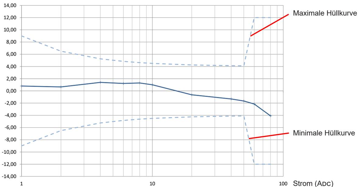
Typische Amplitudenfehlerkurve für AC-Strom 60 Hz im Messbereich 10 mV/A
