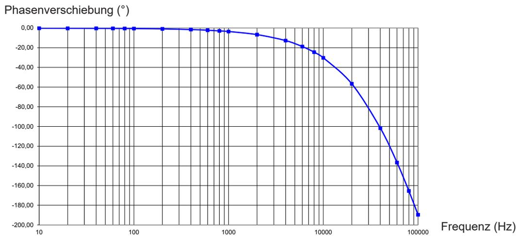
Typische Phasenverschiebung als Funktion der Frequenz,  $I = 0,5 \text{ A}$ , im Messbereich  $1 \text{ V/A}$
