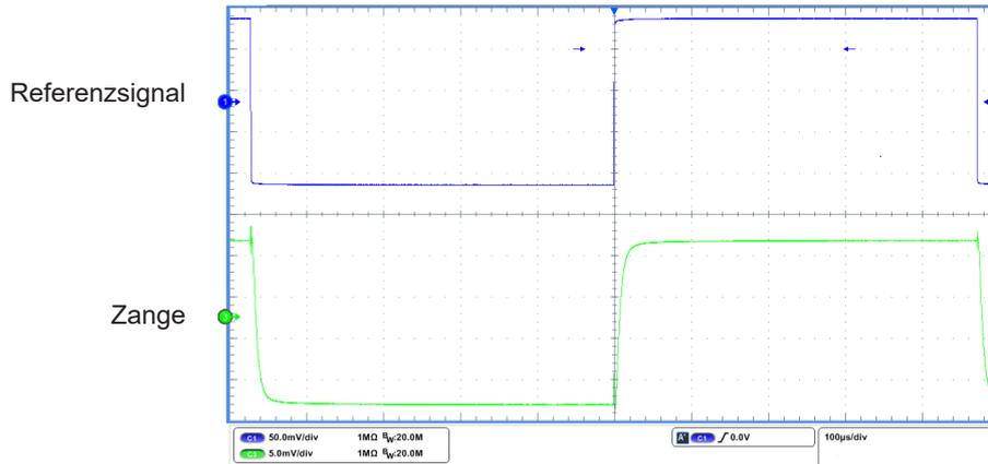
Impulsantwort bei  $\pm 0,5$  A Peak bei 1 kHz Frequenz im Messbereich 1 V/A
